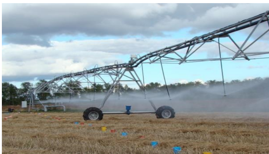
Рисунок 1 – Схема (а) и фото (б) дождевальная машина ферменной конструкции «Волга-ФК1» с полиэтиленовым трубопроводом
